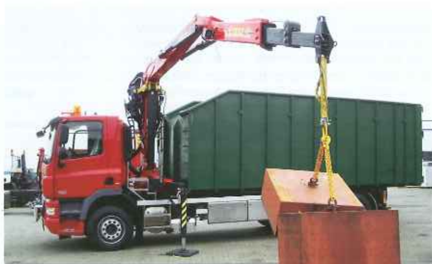
Het project had ten doel inzicht te krijgen in de torsie die optreedt bij het gebruik van een autolaadkraan, met als einddoel te komen tot een lichtere opbouw.
